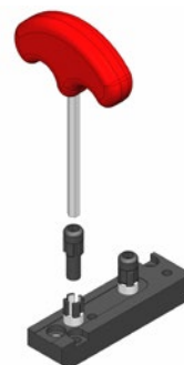
Moving of screw thanks to the extraction set Schrauben Versatz mit Umbau-Set Déplacement de la vis grâce au set d'extraction
