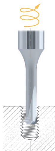
2 Usinage au Ø fini du filetage en remontant
