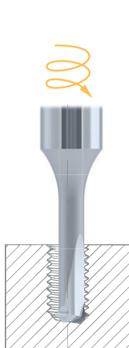
1 Plongée en spirale au Ø d'ébauche (Ø fini -2%)
