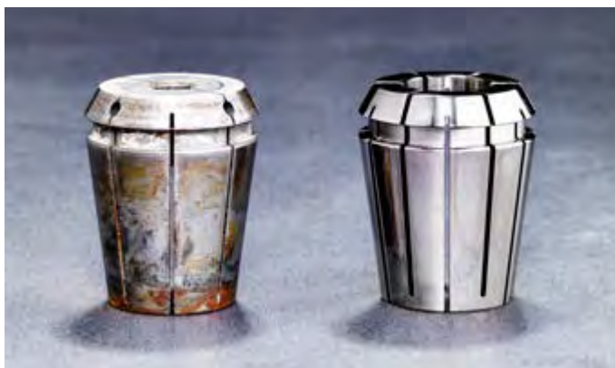
Deux pincettes de serrage après 4 mois d'utilisation respectivement: A gauche sans revêtement – à droite avec FAHRION|Protect
